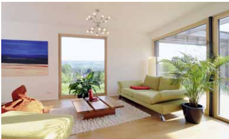
6 Die Verglasung der Fenster trägt mit zur Aussteifung der Flügelrahmen bei. So konnten die Rahmen sehr schmal gehalten werden, was die solaren Einstrahlungsgewinne erhöht und natürlich dem traumhaften Ausblick gerecht wird.
